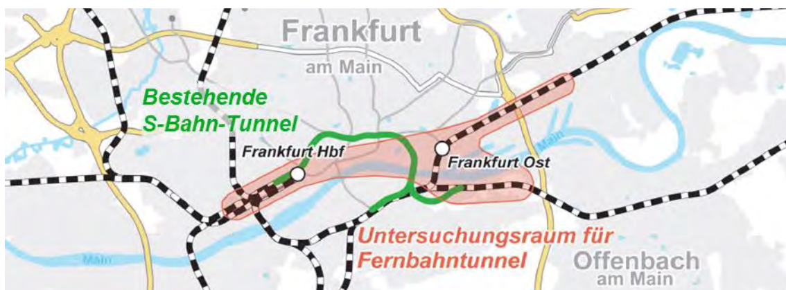
Abbildung 126: Geplanter Fernbahntunnel in Frankfurt
