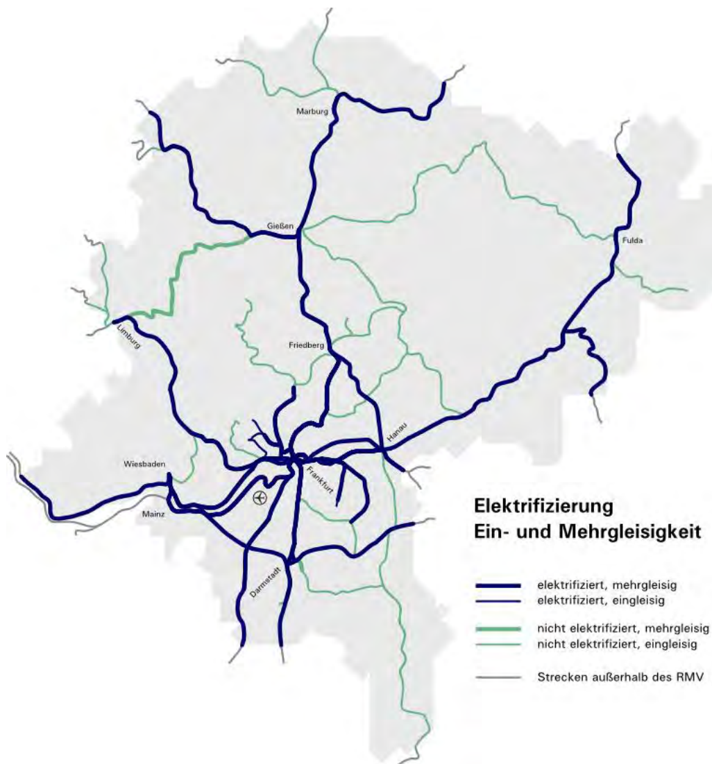
Abbildung 39: Eisenbahninfrastruktur im Gebiet des RMV
